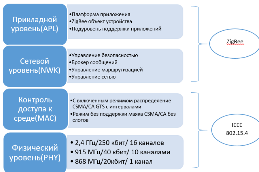
Рисунок 4.4 - Структура протоколов 802.15.4
