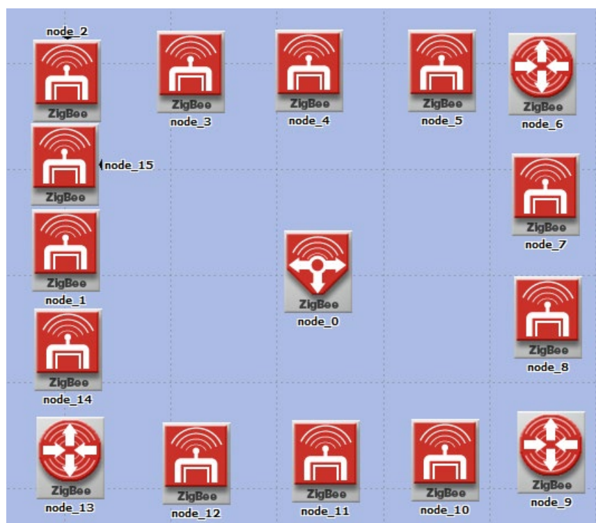
Рисунок 4.8 – Симуляция звездообразной топологии
