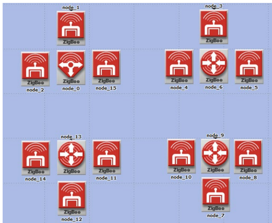
Рисунок 4.9 – Симуляция сетчатой топологии
